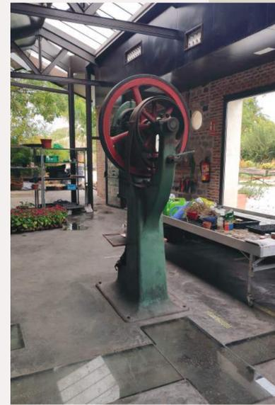
Antigua máquina cachadora. Las canaletas cubiertas con cristales alojaban el árbol que trasmitía el movimiento a la máquina.
